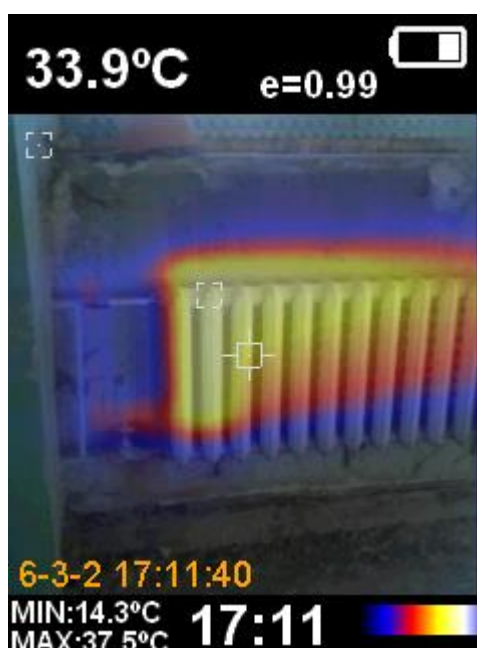
Фото 39. Пристройка ЦИК, 4 этаж, система отопления в ограниченно работоспособном состоянии.
