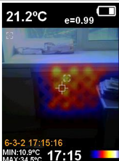
Фото 71. Пристрейка ЦИК, 3 этаж, система отопления в ограниченно-работоспособном состоянии, максимальная температура 34,5 гр.
